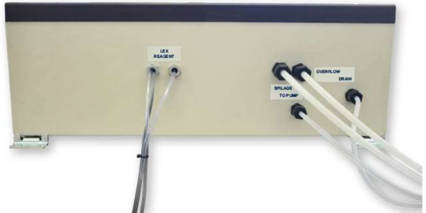
Figura 37: Conexiones de tuberías en la parte inferior de la Unidad del Analizador para el derrame, residuos (drenaje) y el lado de succión de la bomba
