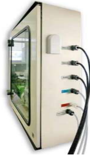
Figura 15: Conexiones de tuberías en la parte lateral de la Unidad del Analizador
